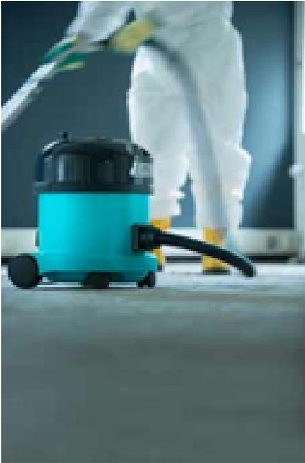
**Aan stofzuigers die worden ingezet bij het verwijderen van gezondheidgevaarlijke stoffen zoals asbest, worden extra hoge eisen gesteld. Deze stofzuigers dienen voorzien te zijn van een filtersysteem die bovendien vóór de zuigmotor geplaatst moet zijn om asbestvervuiling van de motor te voorkomen.**
