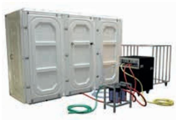
Die Dekontaminations-Einheit besteht aus separaten Tür-, Wand-, Boden- und Dachpaneelen, die mithilfe der Befestigungsclips montiert werden, die fest an den Paneelen befestigt sind. Diese Clips werden mit dem im Lieferumfang enthaltenen Schlüssel festgezogen. Die Paneele sind mit Dichtungstreifen aus hochwertigem Gummi ausgeführt.
